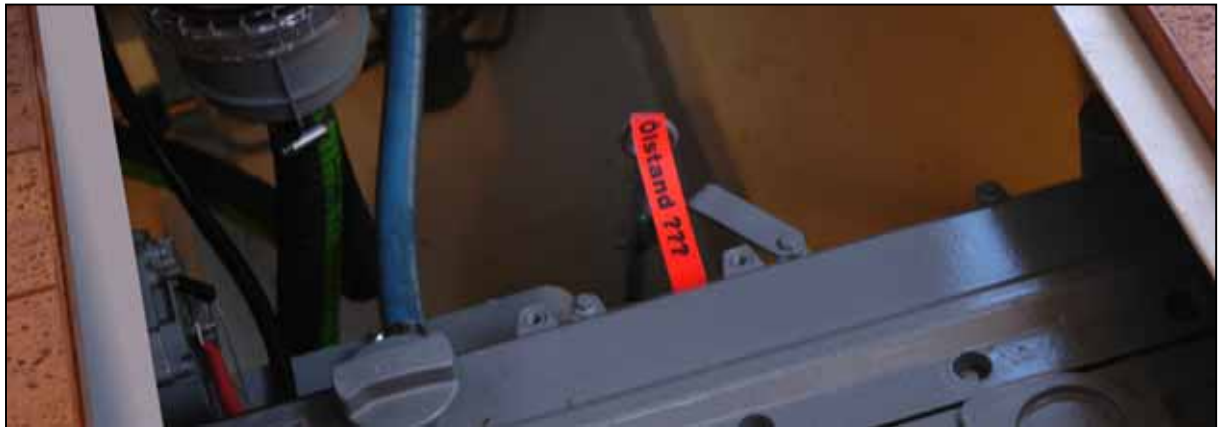
Nicht zu übersehen: Der Ölpeilstab am Motor.
